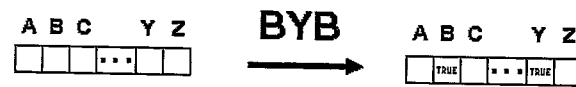
Рис. 1 На рисунке пустые элементы равны False; элементы, равные True, присутствуют в исходной строке «BYB»
