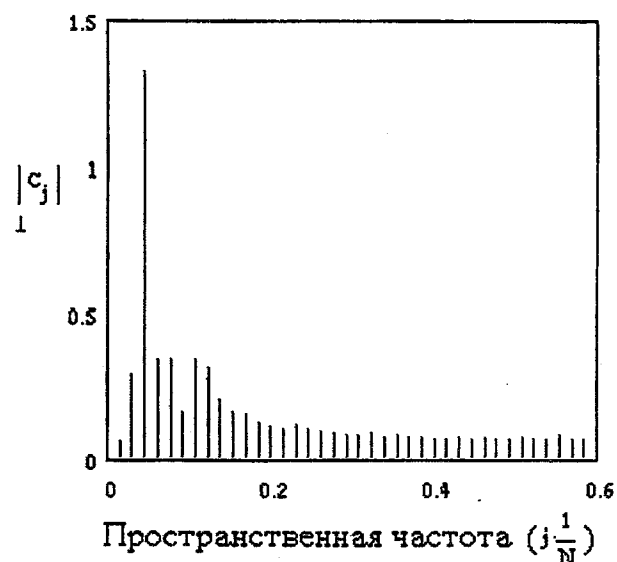
Рис. 4. Спектр размеров реологической структуры ( c_j ); \alpha = -0,1 \beta = 1,25 \chi = 0,1
