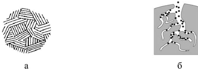
Рисунок 2. Строение частиц: а – частицы пиролизного углерода, б – частицы активированного угля.
