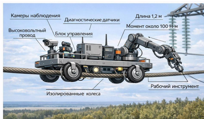
Рис. 2. Концептуальная конструкция роботизированной платформы
