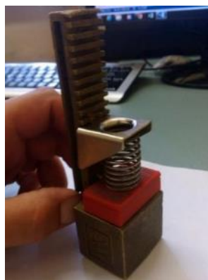
Рис. 3. Конструкция щеткодержателя с прототипом ДЩ из ABS
