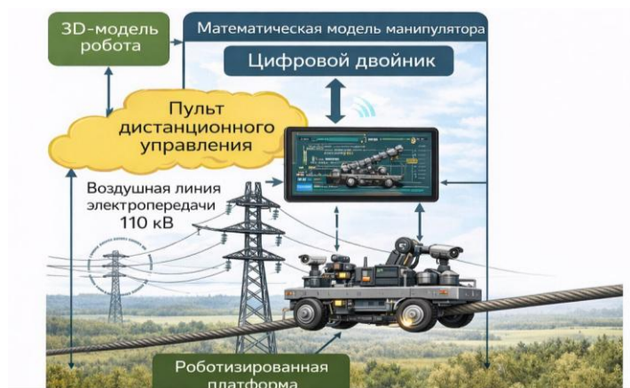
Рис. 1. Структурная схема роботизированного электротехнического комплекса
