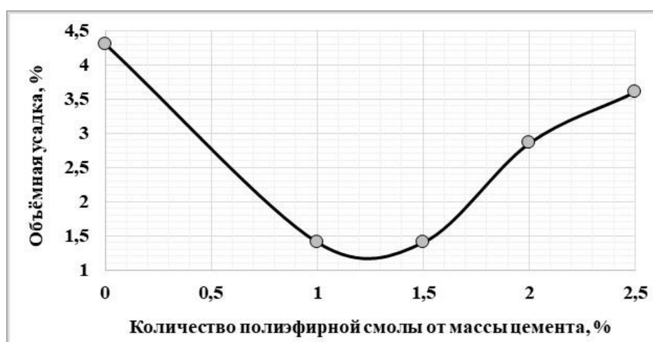
Рис. 2. Зависимость объёмной усадки от содержания полиэфирной смолы в полимерцементном тесте
