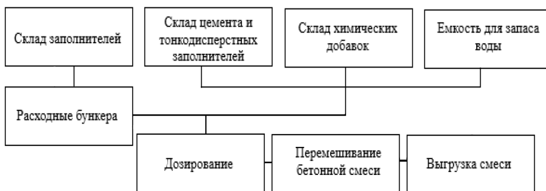
Рисунок 3. Схема технологического процесса при приготовлении бетонной смеси.
