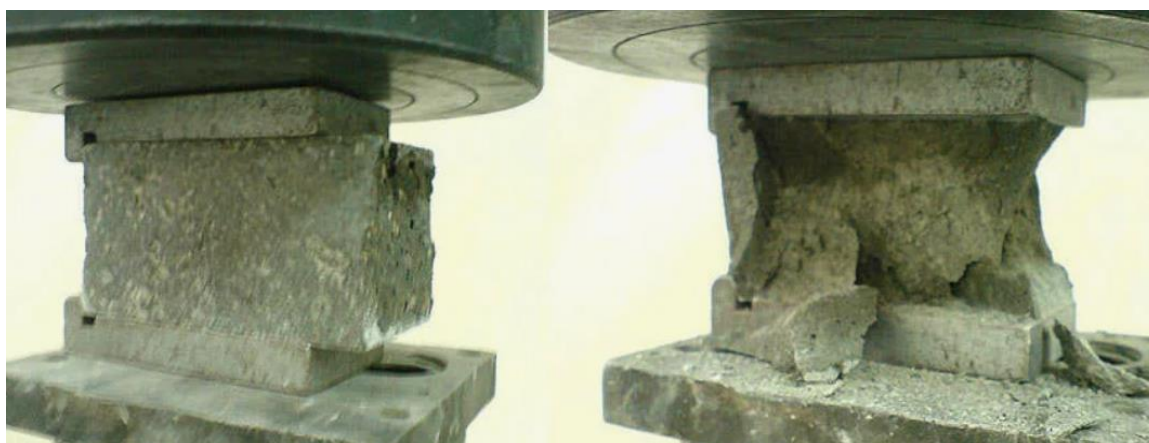
Рисунок 2. Общий вид испытания на сжатие образцов-балочек.
