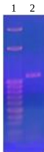
Рисунок 1. Электрофореграмма синтезированной в ПЦР ДНК-вставки Линия 1 – ДНК-маркеры. Длина ДНК-фрагментов сверху вниз (п.н.): 3000, 2000, 1000, 900, 800, 700, 600, 500, 400, 300, 200, 100. Линия 2 – ДНК-вставка 1111 п.н. Фрагменты разогнаны в 1,5 % агарозном геле
