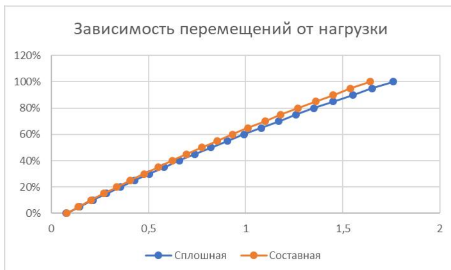
Рисунок 6. График зависимости перемещения точки С от нагрузки.
