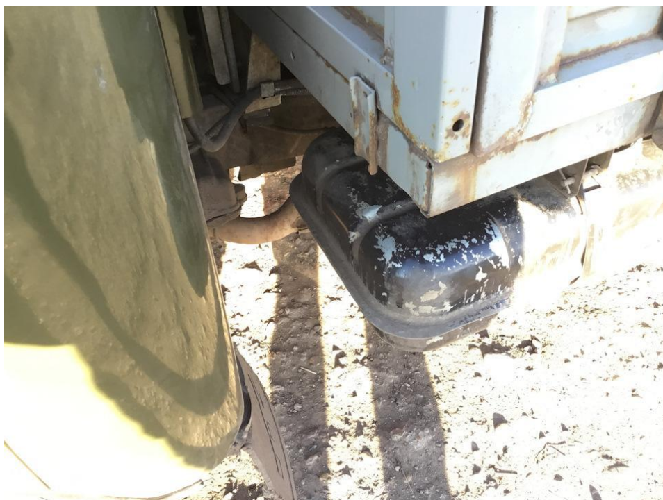
Рис. 2. Разрыв рамы между кабиной и бортом, вид 1
