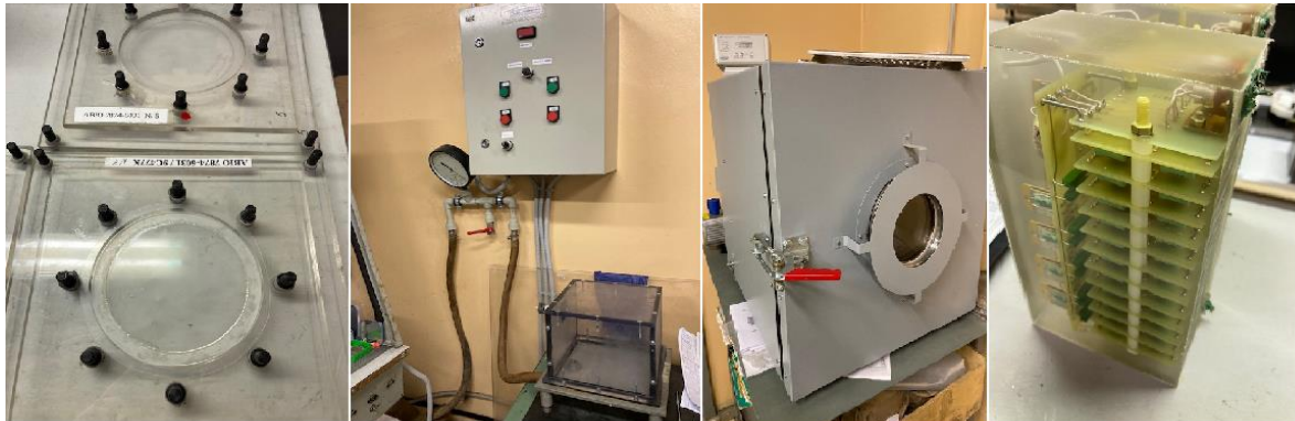
Заливка образцов на пробой
