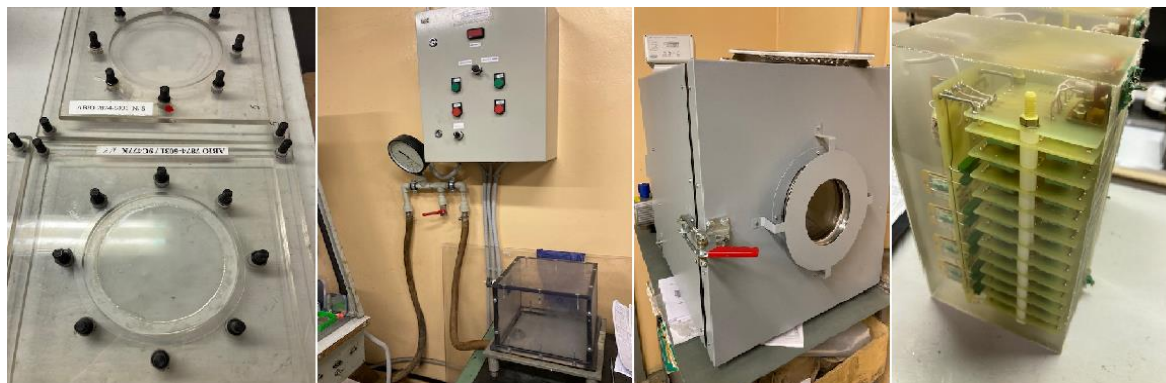
Заливка образцов на пробой
