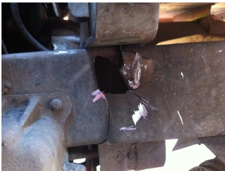
Рис. 2. Разрыв рамы между кабиной и бортом, вид 2
