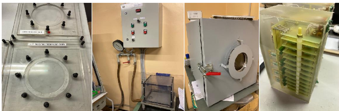
Заливка образцов на пробой
