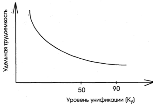
Рис. 1. Зависимость между удельной трудоёмкостью (отношение трудоёмкости к важнейшему параметру) изготовления объекта и уровнем его унификации
