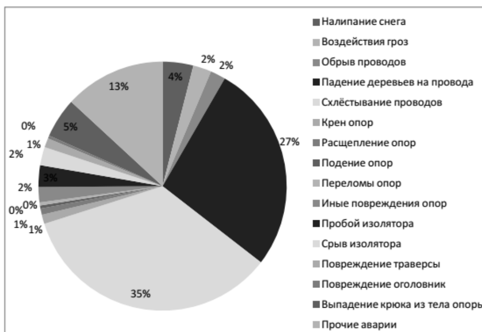
Диаграмма повреждений ВЛ 10кВ за 6 лет северного района Кировской области
