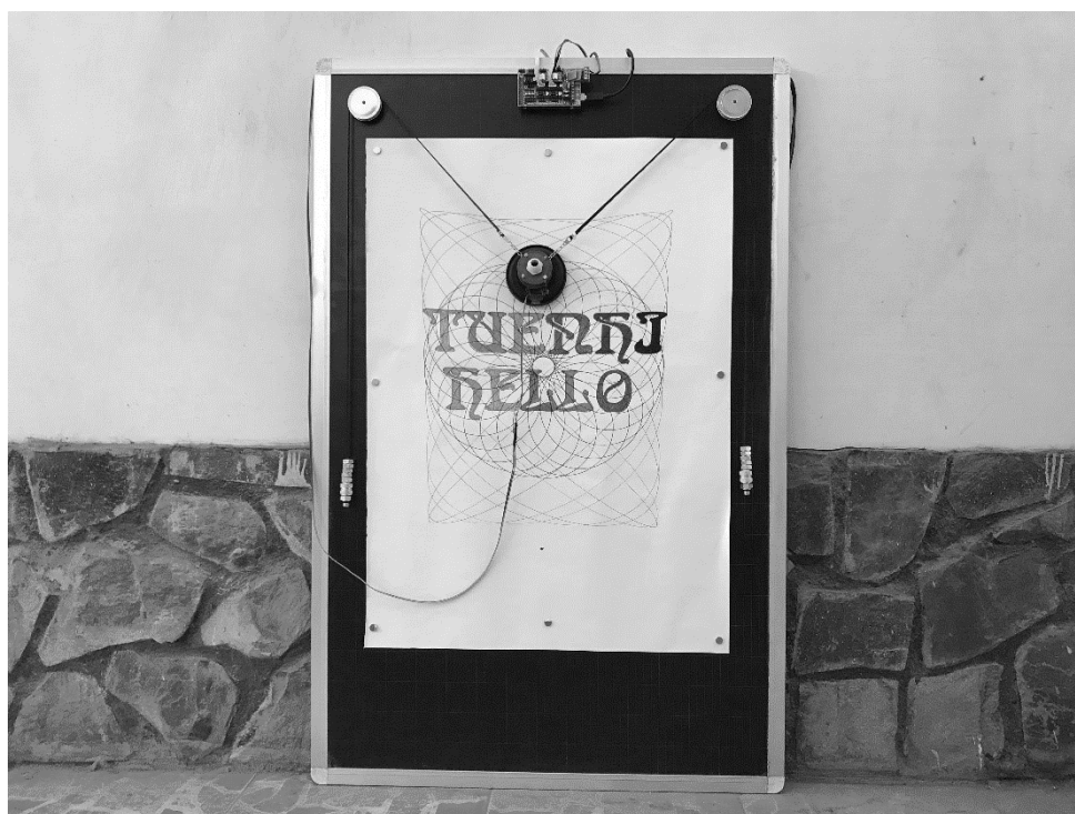
Рис. 1. Модель вертикального 3D-плоттера
